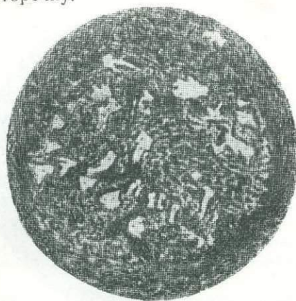
Рис. 32. Ячеестое строение гематита
