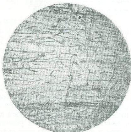
Рис. 4. Лучистые агрегаты рамдеалита. Полированный шлиф. Ув. 40. Эльвор.
