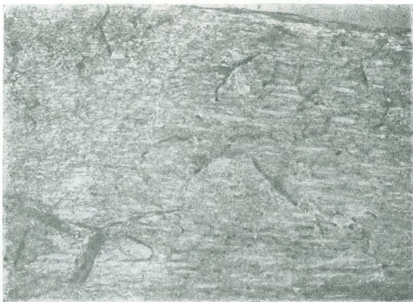
Рис. 9. Сланцеватая текстура с ориентированным расположением алунита (белые).
